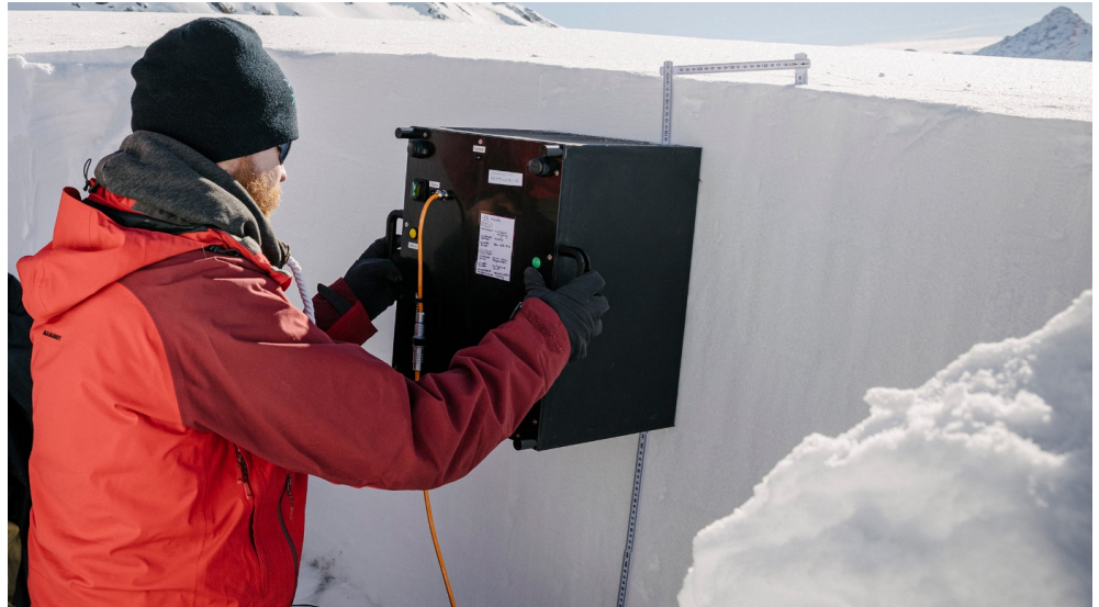
SLF-Physiker Lars Mewes misst mit dem Prototypen des Snowmagers den Aufbau der Schneedecke im Pischagebiet. Foto: Bruno Augsburger / SLF
